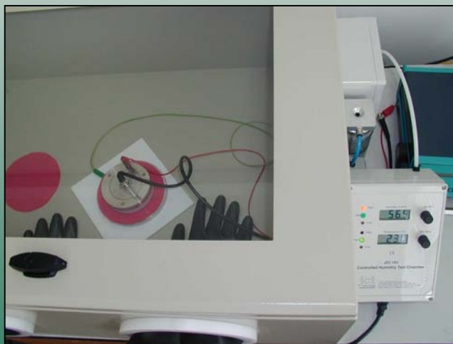
Prietaisas elektrostatinėms savybėms nustatyti
