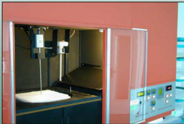
Prietaisas šiluminiam atsparumui ir atsparumui vandens garams nustatyti
